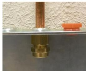
**Racor bicono (Código 404304):** Entrada de gases para conexión a tubo de Cu de  $\varnothing 10$  mm y a transmisor con rosca  $\frac{1}{4}$ " BSP-M.
